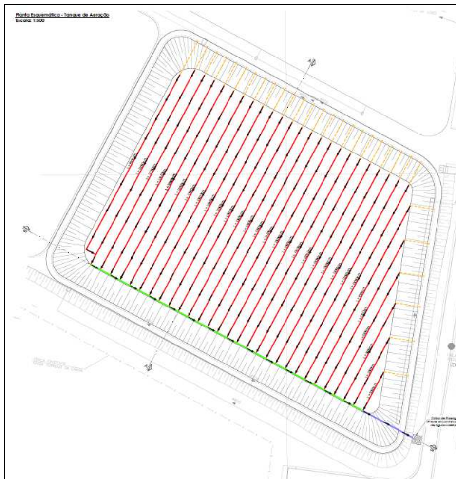
Figura 21 - Lay out do sistema de drenagem
