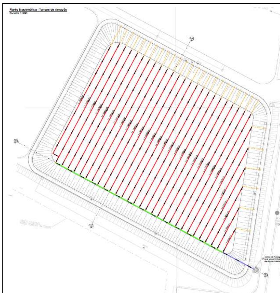
Figura 18 - Lay out do sistema de drenagem
